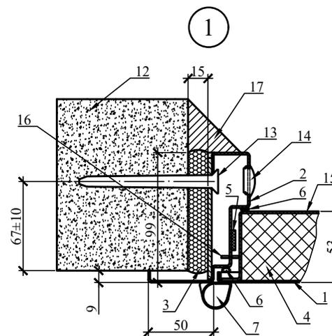
1. Полотно металлическое противопожарное EIS60, металл - 1,5 мм. 08ПС ГОСТ 16523-97.
