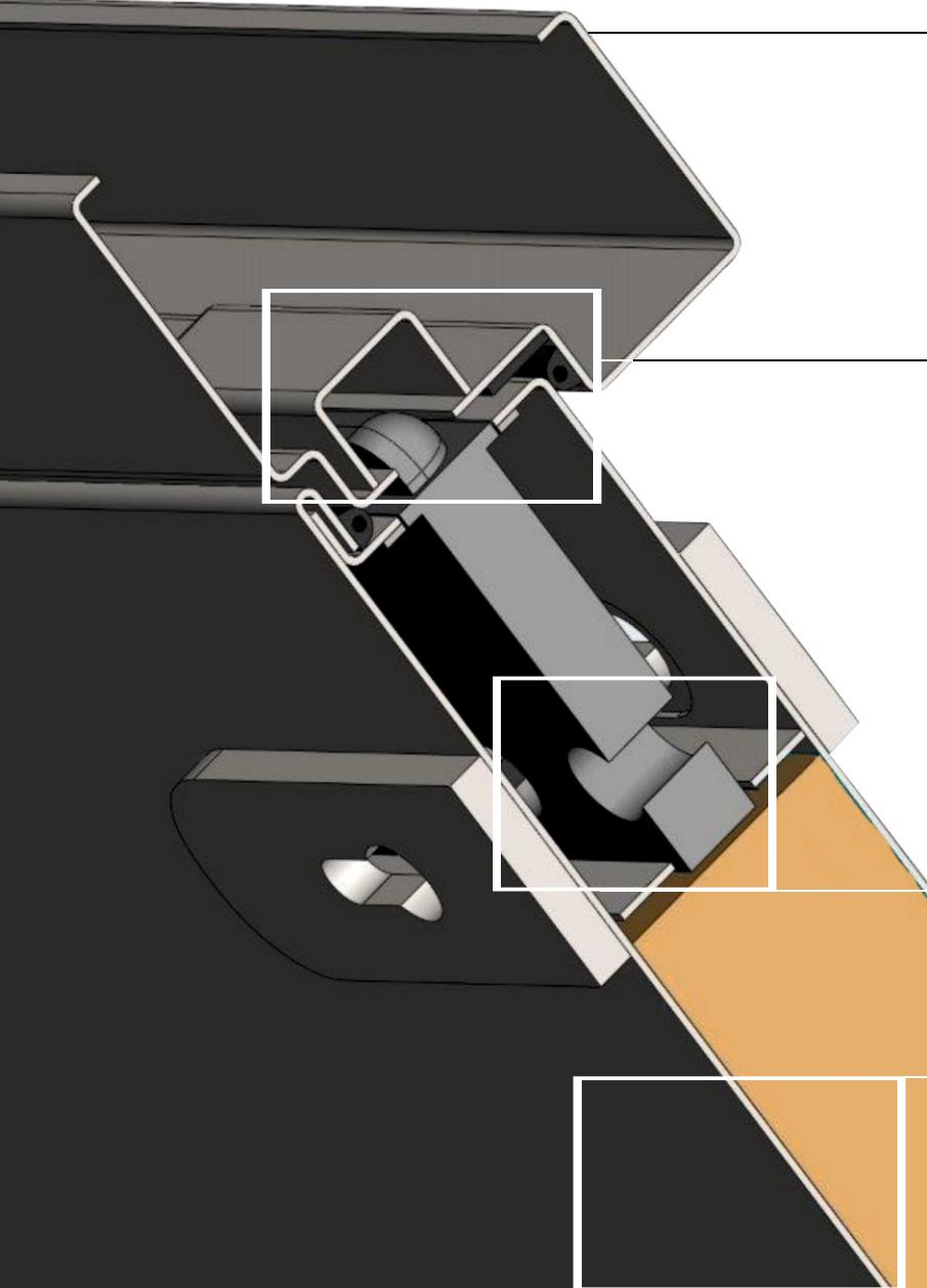
Коробка двери – гнутый профиль коробчатой конструкции, объединенный с наличником. Материал – сталь листовая холоднокатаная 1,5 мм.
